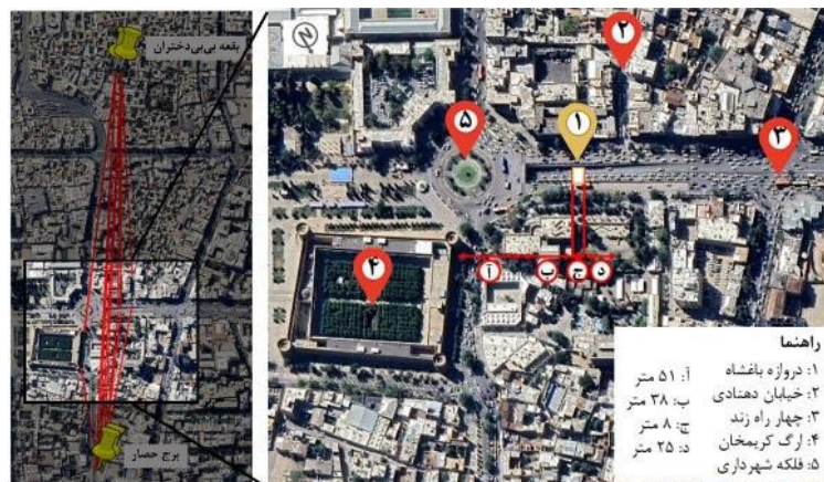
تصویر ۲۱: ترسیم امتداد خطوط تعیین موقعیت نسبی عناصر و فضاها (چپ) و موقعیت مکانی دروازه باغشاه در وضعیت موجود براساس فواصل محاسبه شده برای عناصر و فضاها (راست)
