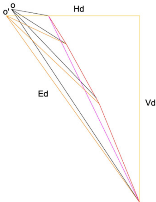
تصویر ۱۸: سمت چپ: نمودار آنتی فونیکولار قوس قطری
