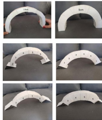
تصویر ۶: چیدن قوس با تناسبات مختلف. در سمت چپ، قوس با ضخامت کمتر و در سمت راست، قوس ضخیم‌تر چیده شده‌اند. و از بالا به پایین به تدریج، خیز قوس کاهش می‌یابد. قوس نیم‌دایره لاغر (بالا-چپ)، به دلیل ضعف در پایداری، با دست در جای خود نگاه داشته شده است! مدل‌سازی و عکس از دانشجو: محدثه رزانی، درس سیستم‌های ساختمانی، ۱۳۹۹.
