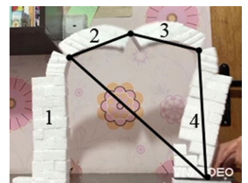
تصویر ۱۳: ارتباط هندسی ترک‌ها و مدل میله‌ای. مدل‌سازی، فیلم و عکس از دانشجو: فاطمه عرب‌پور، درس سیستم‌های ساختمانی، ۱۳۹۸
