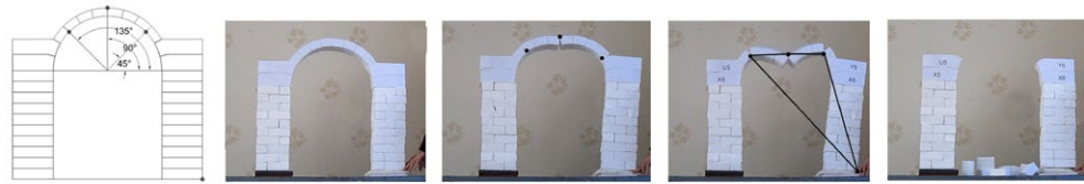
تصویر ۱۵: فروریختگی در حالت قوس ضعیف - پایه قوی. بعد از فروریختن قوس، پایه احیا می‌شود.
