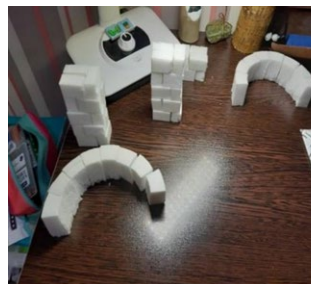
تصویر ۴: راست: هندسه قوس. چپ: آماده‌سازی قطعات قوس بدون چسباننده. اثر دانشجو: کیمیا افلاطونیان، درس سیستم‌های ساختمانی، ۱۳۹۸
