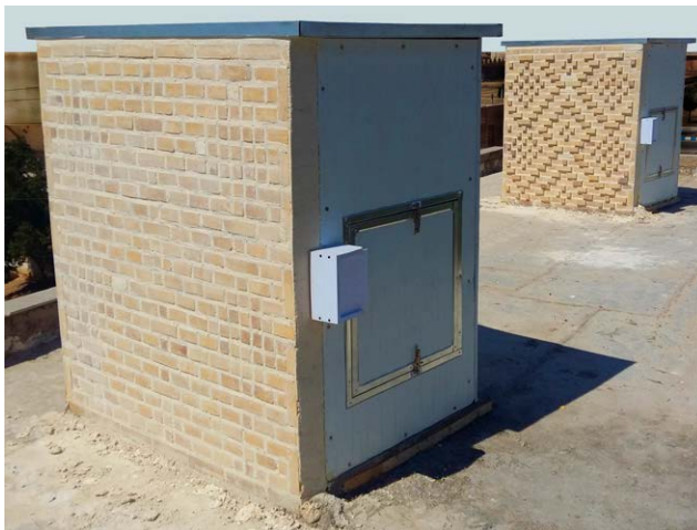
تصویر ۳: اتاقک A با نقش بدون برجستگی و اتاقک B با نقش خون‌چینی برجسته بر نمای جنوبی آن‌ها
