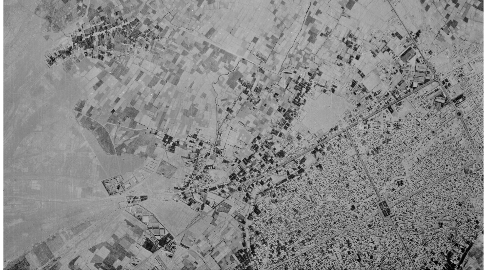
تصویر ۱۱: محدوده شمال غربی کاشان در سال ۱۳۴۳. در گوشه سمت چپ و پایین تصویر، رد قنات و میله‌های آن دیده می‌شود. در عین حال مسیر جوی‌های آب در شمال صالح‌آباد قابل مشاهده است که آب را به نواحی شمال شرقی و پایین دست منتقل می‌کنند (سازمان نقشه‌برداری کشور).
