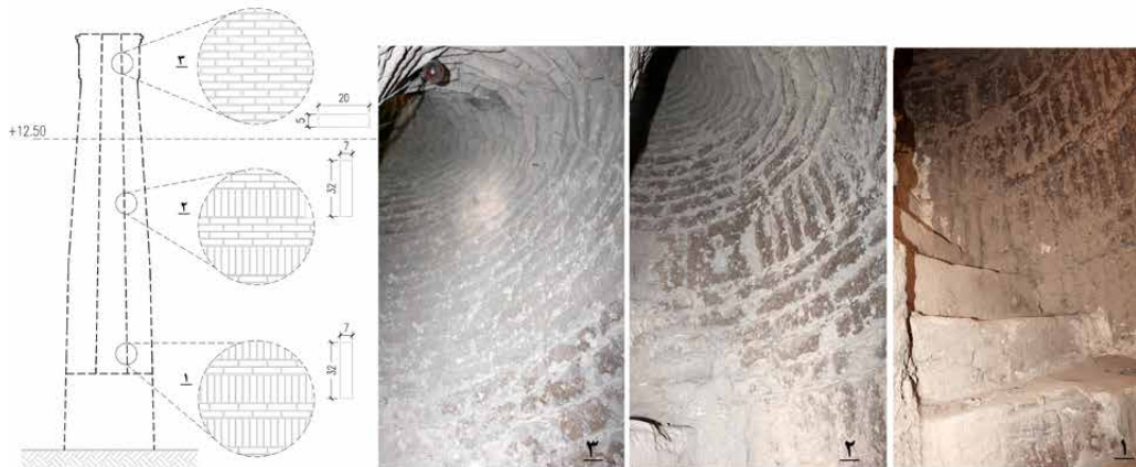
تصویر ۱۳: چیدمان آجرها در بخش‌های مختلف پایه
