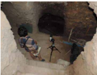
تصویر ۸: اندازه‌گیری وضعیت حرارتی در حیاط و شوادان خانه سوزنگر
