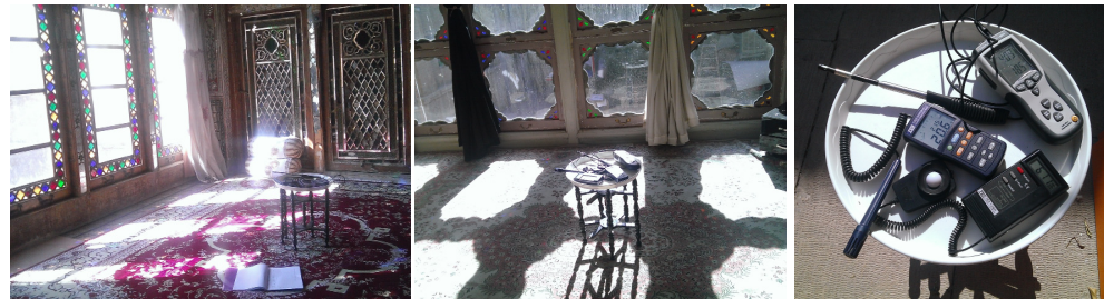
تصویر ۸: برداشت متغیرهای آب‌وهوایی توسط دستگاه در داخل اتاق‌های انتخابی
