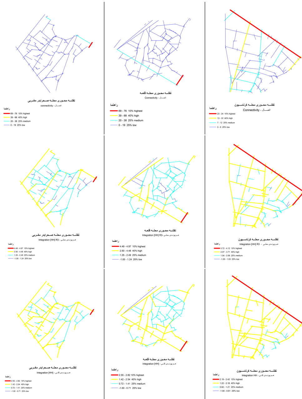
تصویر ۷: نقشه‌های محوری محیط مصنوع سه محله براساس شاخص‌های اتصال، هم‌پیوندی محلی و هم‌پیوندی کلی (فراگیر)
