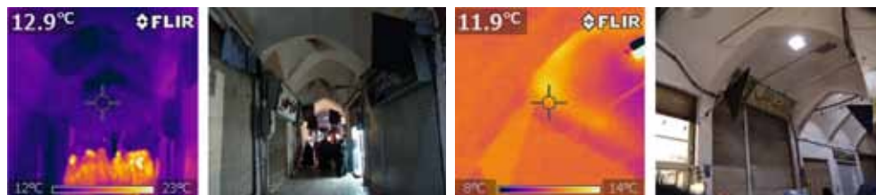
تصویر ۳۷: حضور جمعیت و نقش تأخیر حرارتی مصالح در افزایش دمای محیط بازار در عصر (راست) و شب (چپ) زمستان
