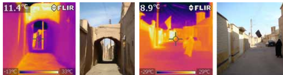
تصویر ۲۴: مقایسه وضعیت گرمایی گذرهای باریک سرباز (راست) و سرپوشیده (چپ) در زمستان
